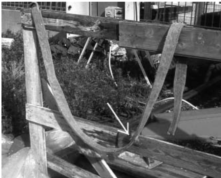
Braca in fibra non regolare in quanto sfilacciata
